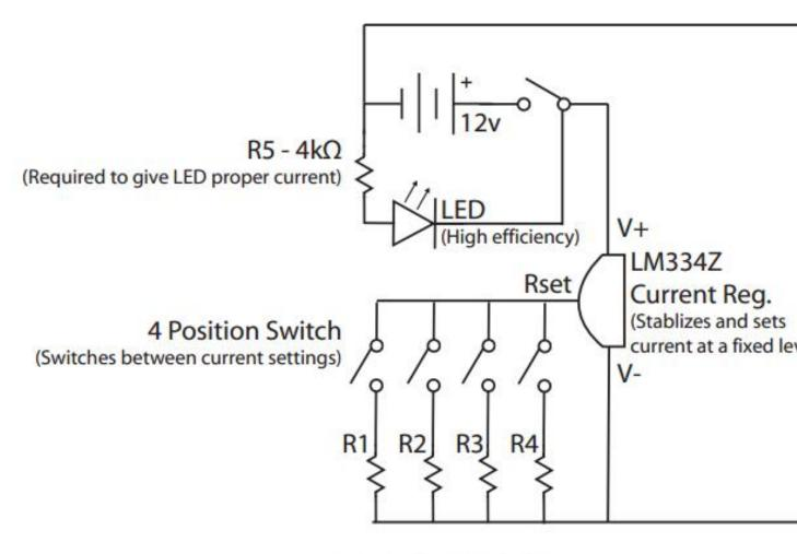
R1 - 33Ω ~ 2.0mA R2 - 50Ω ~ 1.5mA R3 - 66Ω ~ 1.0mA R4 - 80Ω ~ 0.5mA
